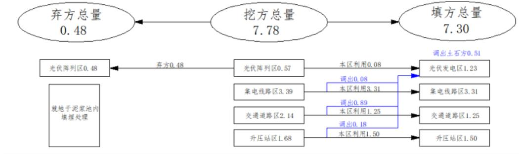
图 2-1 土石流向图 单位：万m<sup>3</sup>
