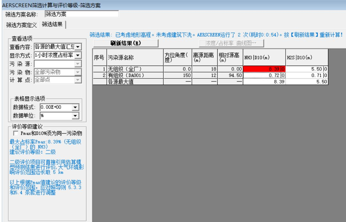
图 2.4-1 AERSCREEN 模型筛选计算结果
